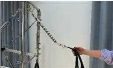
17. Hängen Sie die Zugringe ⑯ ein.
